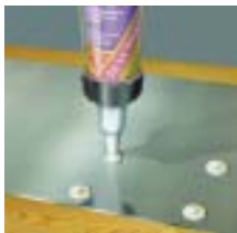
Līmes uzklāšana elastīgai līmēšanai punktveida vai stīgas formā. Atkarībā no virsmas gluduma pakāpes līmes šuvi saspiež līdz 1–3 mm biezumam
