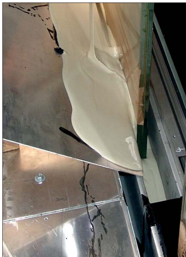
8. attēls. Vienkārša SikaGlaze® GG-735 ieklāšana, izmantojot slīpi novietotu metāla loksni
